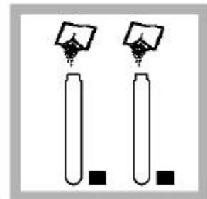
4. 在每个 TNT 管中加入一个氨水杨酸试剂粉枕，此试剂适用于 5mL 水样的测量
