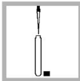
2. 加 0.1ml 的水样于一个测定高量程氨氮的 AmVer 稀释试剂 TNT 管（此为待测水样）
