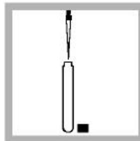
3. 加 0.1ml 的无氨水于一个测定高量程氨氮的 AmVer 稀释试剂 TNT 管（此为空白）
