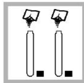
5. 在每个 TNT 管中加入一个氨氰尿酸试剂粉枕
