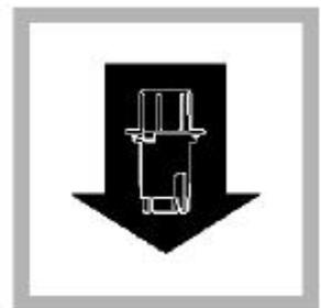
8. 擦干装有空白试剂的 TNT 管，将其放入比色计的管形适配器中；
