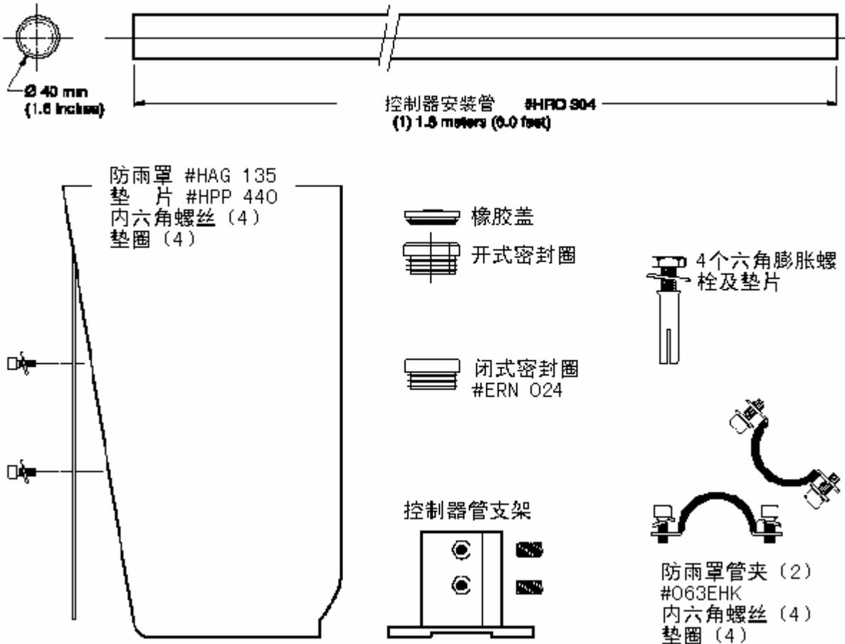
图1 控制器固定点安装附件（货号57344-00）
