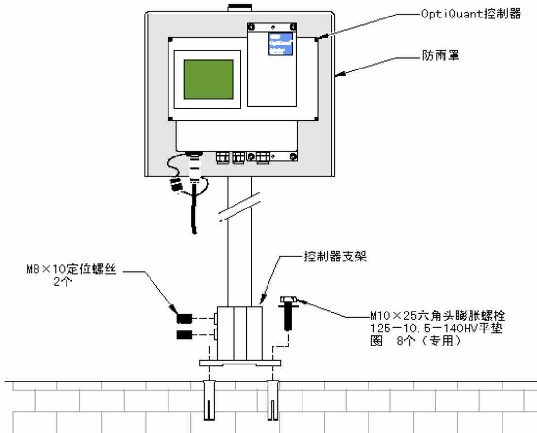
图5 控制器防护安装
