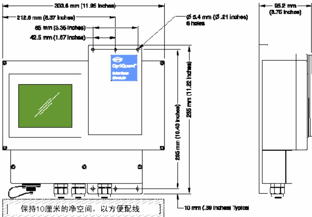
墙上安装，请参考上图，为了配线方便，控制器底部应留有10cm净空间，仪器应远离有害环境，禁止直接安装于太阳底下。
