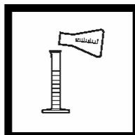
7. 用来自同一烧瓶的样品来装填量筒至 50 mL 刻度线，弃去残留在量筒中的任何残留液体。
