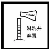
5. 用来自烧瓶之一的样品来装填一个洁净的 50 mL 带刻度的塑料量筒，然后弃去量筒中的液体。
