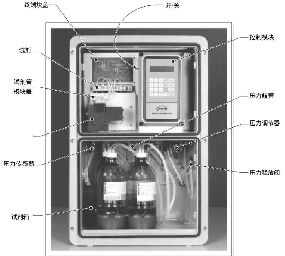
所有的测定仪功能都是由基于微处理的电路所控制的。用户可编程的操作设置被保存在存储器中，通过备用电池在掉电时保护仪器。测定仪性能是连续自我监测的，并使用一个报警系统来通知操作者有任何影响分析的情况发生。测定系统有两种级别的报警：系统警告报警意味着需要操作者注意，而系统警报则意味着故障已经迫使测定仪关机。
