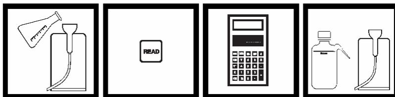
17. 等待 15 秒以显色，然后将第二个烧瓶中的液体倒入到流通池中。
