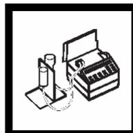
3. 安装流通池，用 50 mL 的去离子水来冲洗。
