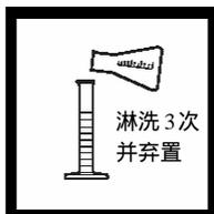
6. 用同样的样品烧瓶重复量筒淋洗过程三次，弃去每一次的淋洗液。
